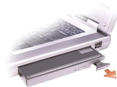
3. Das neue Gerät in den Schacht einschieben, bis es mit einem hörbaren Klicken einrastet.
