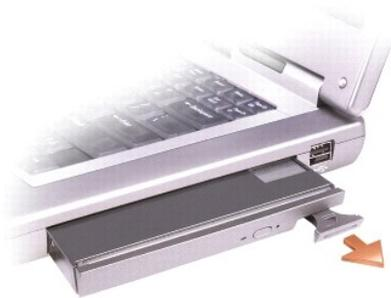
5. Das neue Gerät in den Schacht einschieben, bis es mit einem hörbaren Klicken einrastet.
