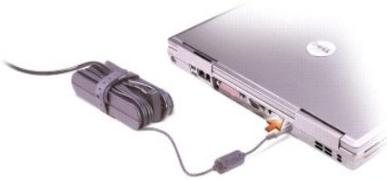
Der Netzadapter wandelt Wechselspannung in die vom Computer benötigte Gleichspannung um. Sie können den Netzadapter bei ein- oder ausgeschaltetem Computer anschließen.
