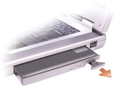
5. Das neue Gerät in den Schacht einschieben, bis es mit einem hörbaren Klicken einrastet.
