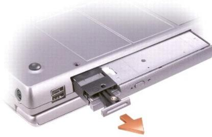
7. Das neue Gerät in den Schacht einschieben, bis es mit einem hörbaren Klicken einrastet, und die Schraube wieder eindrehen.
