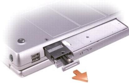
➔ **VORSICHT:** Setzen Sie Geräte in den Modulschacht ein, bevor Sie den Computer an ein Docking-Gerät anschließen und einschalten.
