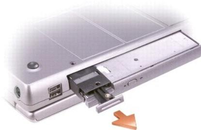
5. Das Gerät aus dem Modulschacht herausziehen.
